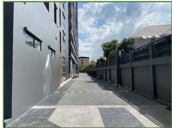
ภาพที่ 5 สันนูลลดความเร็วภายในโครงการ
